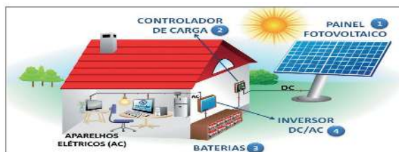
Figura 7: "Ilustração do sistema fotovoltaico" (VILLALVA, 2012).
